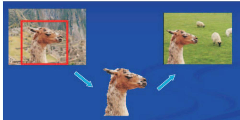
Значения скрытых переменных кодируют принадлежность каждого пикселя к объекту либо к фону. Использование графических моделей позволяет учесть, что соседние пиксели чаще всего относятся к одному классу
