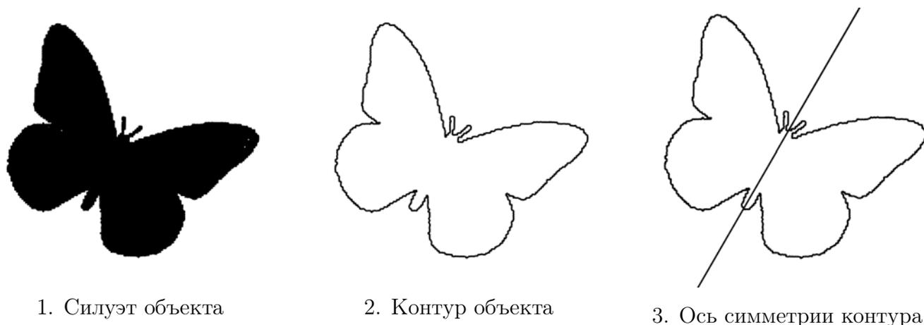
Рис. 2: Решение задачи определения оси симметрии бинарного силуэта
